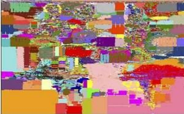
Pode não parecer, mas este é o mapa de um circuito integrado, com diferentes módulos mostrados em cores diferentes. Algoritmos especiais otimizam tanto os locais quanto as formas dos módulos - alguns módulos próximos podem ser mesclados para reduzir o comprimento dos fios de ligação. [Imagem: Jin Hu/Myung-Chul Kim/Igor L. Markov (University of Michigan)]
